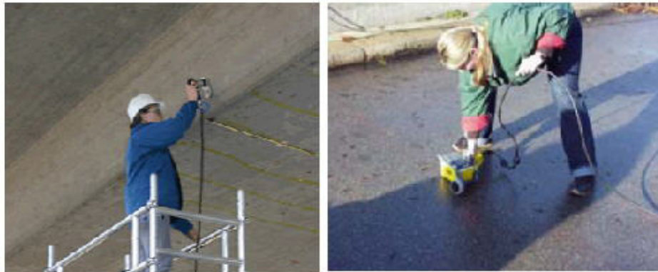
آزمایش با انعکاس صدا (چپ) و GPR (راست)
